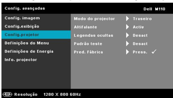
**MODO DO PROJECTOR**—Permite-lhe seleccionar o modo do projector, consoante a forma como o projector estiver montado.
